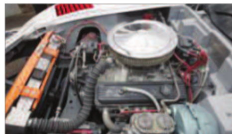
Le moteur ? Un V8 de 5,7 litres de cylindrée et 360 chevaux, flamboyant neuf et acheté chez General Motors. Ça respire bien...
